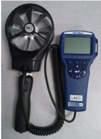
**Figure 2.4. Anemometer**
