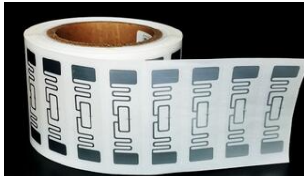
Fig. 10: Passive RFID tags 73x20mm 915 UHF tags
